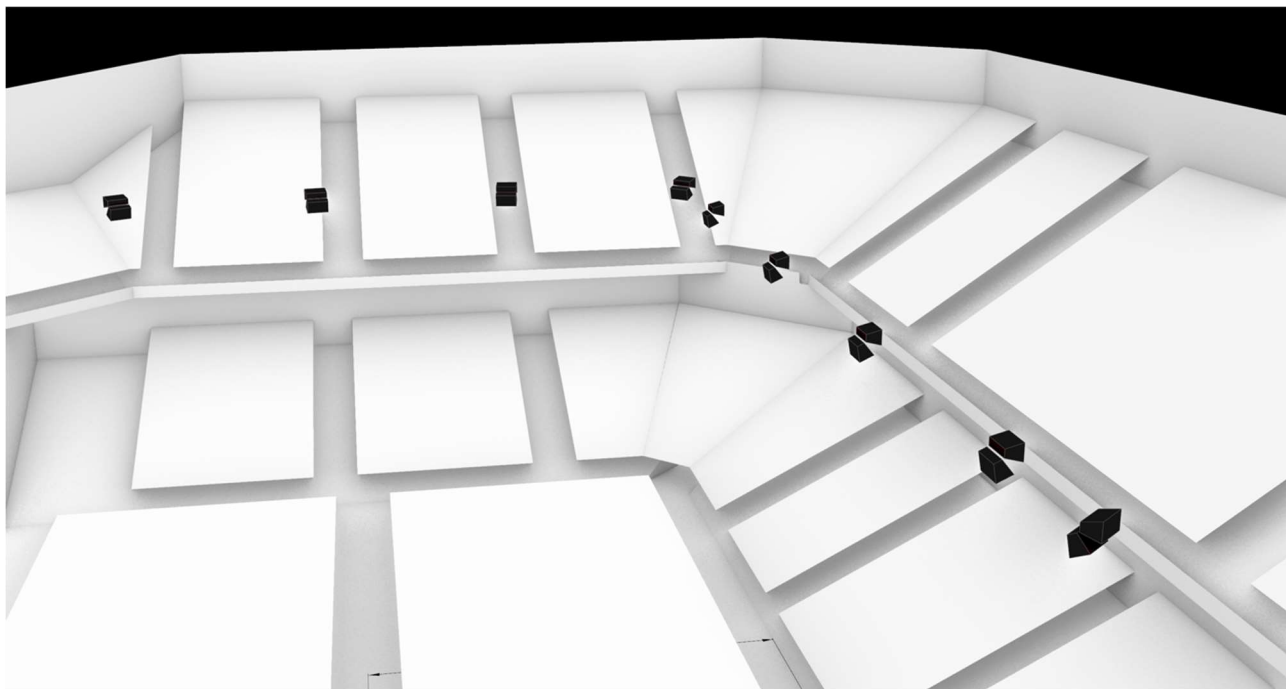
Obr. 2. 3D pohled na reproduktory pro ozvučení tribun.
