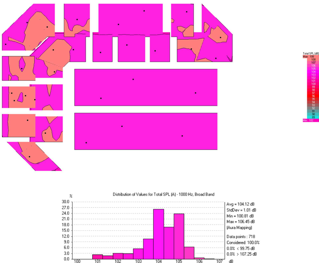
Obr. 8. Simulace celkového akustického tlaku SPL(A). Rozmezí krajních hodnot 101 až 106 dBA.
